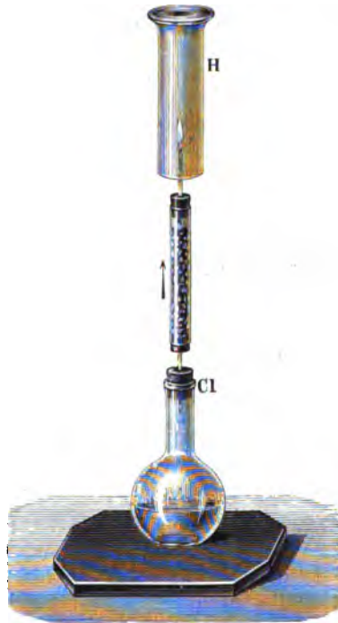
Chlor brennt im Wasserstoffgase.
